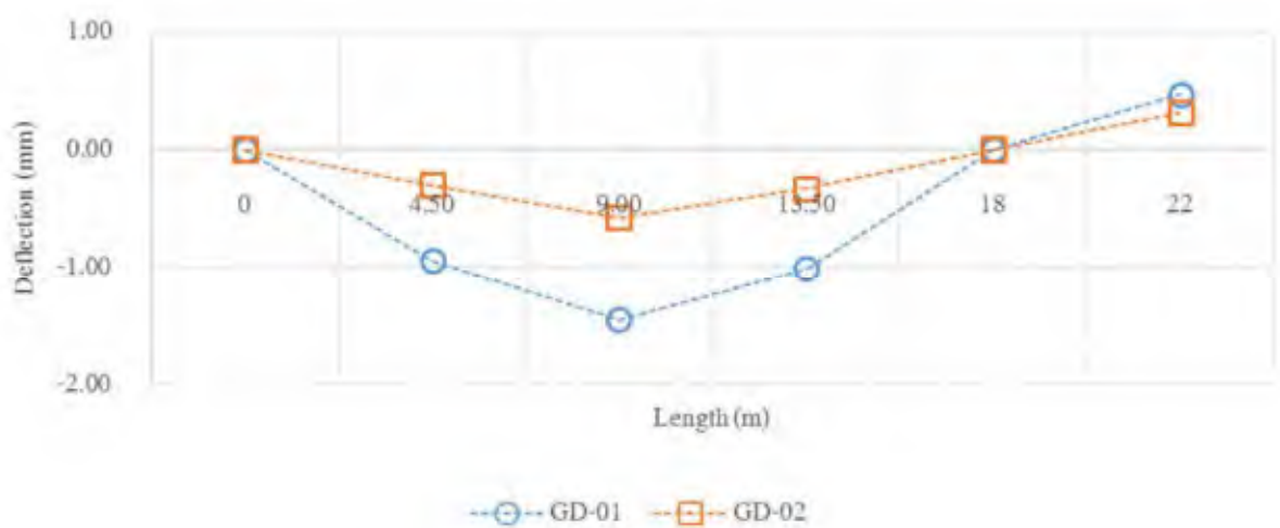
รูปที่ 6.9-7 การกระจายค่าการแอ่นตัวของคานตามยาว Static 2-1 สะพานช่วงที่ 5
