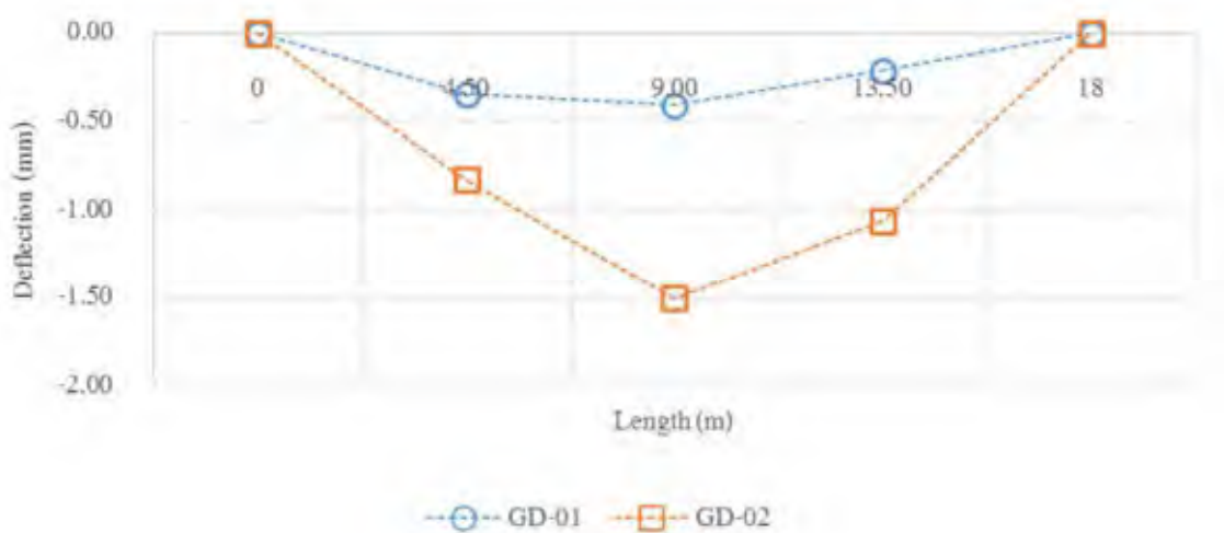
รูปที่ 6.8-9 การกระจายค่าการแอ่นตัวของคานตามยาว Static 2-2 สะพานช่วงที่ 4
