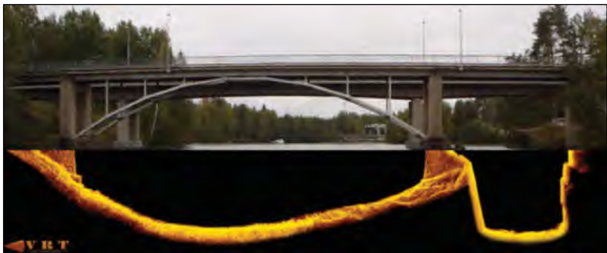
รูปที่ 4-2 ตัวอย่างการสำรวจระดับท้องน้ำด้วยเครื่อง Sonar Scan ประเทศฟินแลนด์
