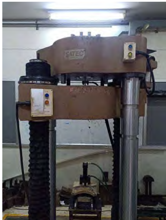
รูปที่ 5-10 การจัดตำแหน่งความยาวพิกัดของเหล็กเสริมกึ่งกลางอุปกรณ์ยึดจับ
