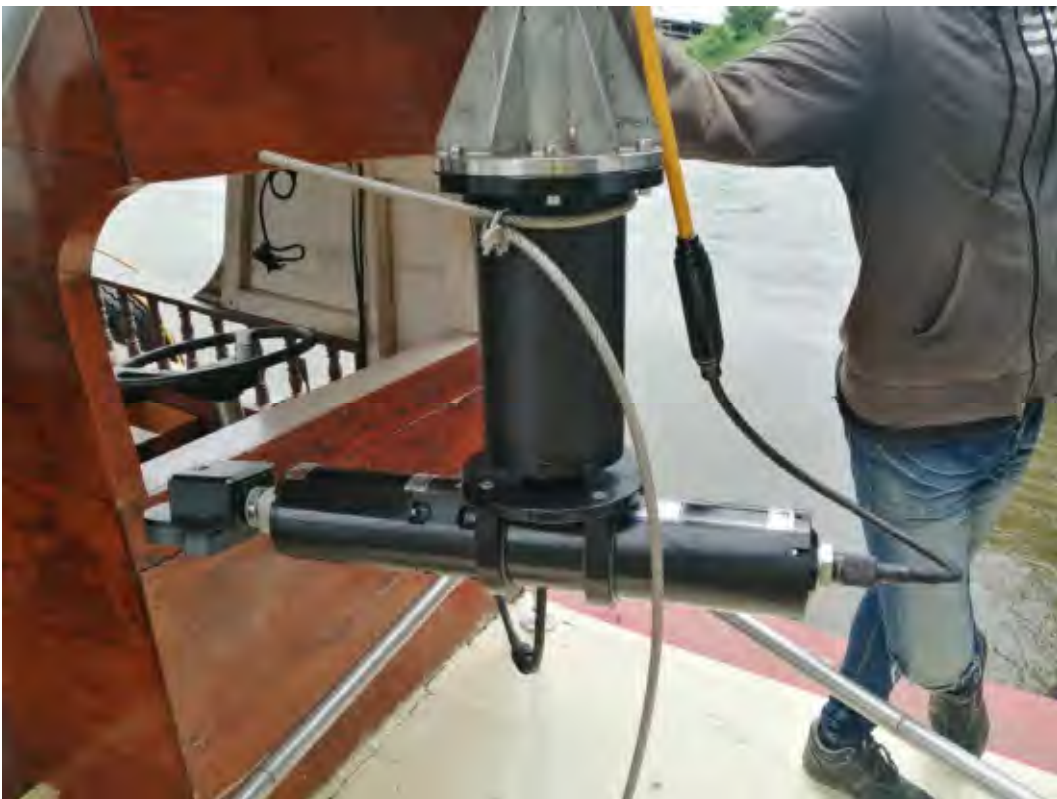
รูปที่ 4-5 การติดตั้ง Rotator และ Sonar Head
