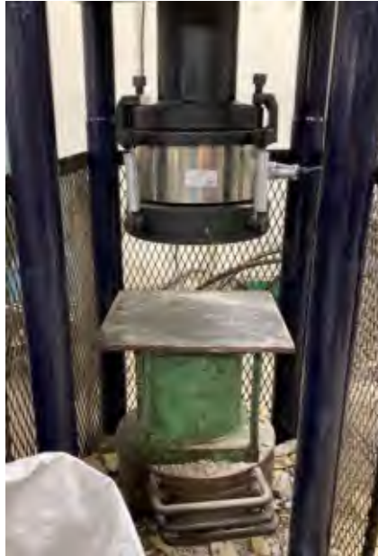
รูปที่ 5-4 เครื่องมือทดสอบกำลังรับแรงอัดของคอนกรีต
